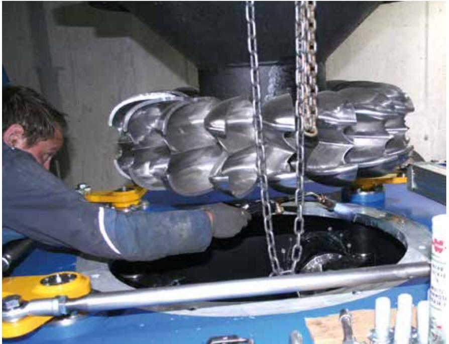
Jede einzelne Schaufel ist aus einem Chrom-Nickel-Stahlblock gefräst
