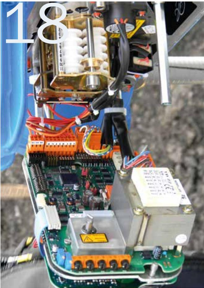
Teil des Steuerungsgerätes für die Turbinenanlage
