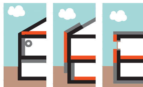
rot = Einsatzbereiche der Dämmstoffe, grau = nicht möglich
