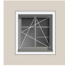
FENSTER NEU 2023 - (V2) 1 Flügel mit Sprossen, Profil IV68, 3-fach-Verglasung Vorstellung mit historischem Bezug
