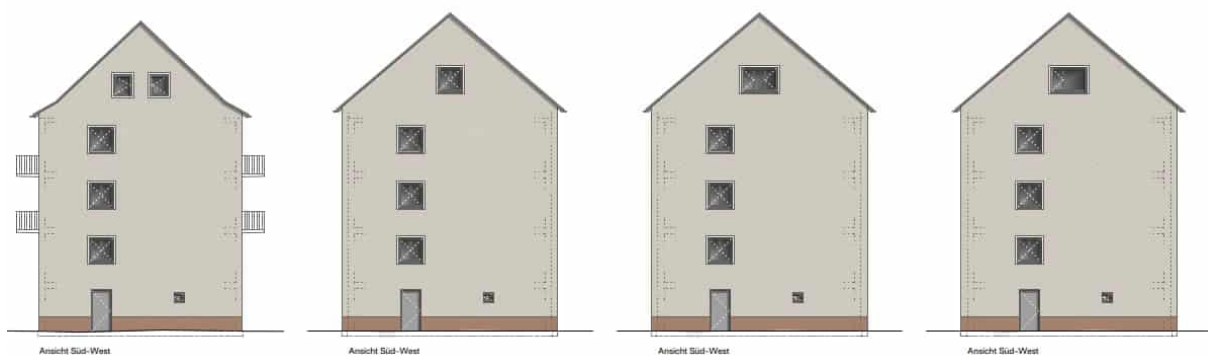
Abbildung 73: Entwurfsvarianten für das Dachgeschoß des größeren Gebäudes ohne Aufschiebling, ohne Kniestock sowie mit zwei Kniestockhöhen; Johannes Kaufmann Architekten
