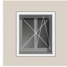
FENSTER SANIERUNG 1970 2 Flügel, Profil IV68, 2-fach-Verglasung
