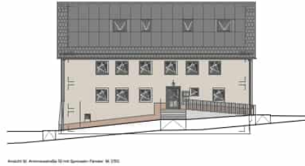
FENSTER NEU 2023 - (V2) 1 Flügel mit Sprossen, Profil IV68, 3-fach-Verglasung Vorstellung mit historischem Bezug
