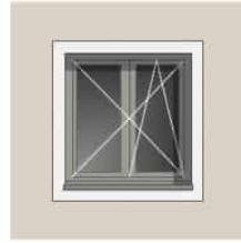
FENSTER NEU 2023 - (V1) 2 Flügel, Profil IV68, 3-fach-Verglasung Aktuelle Planung
