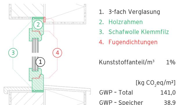
Kunststofffrei sind Holz- oder Holz-Alu-Fensterrahmen und Anschlüsse aus Stopfmateriale wie Mineral-, Flachs- oder Schafwolle sowie Füllmassen auf Korkbasis oder Fugenbänder. Kleinstmengen an Kunststoff sind in Scharnieren und Fugendichtungen enthalten.
