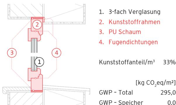
Kunststofffensterrahmen bestehen aus PVC, können zur Verbesserung der wärmetechnischen Eigenschaften auch PU enthalten. PU-Schaum wird zur Dämmung der Fensteranschlüsse verwendet.
