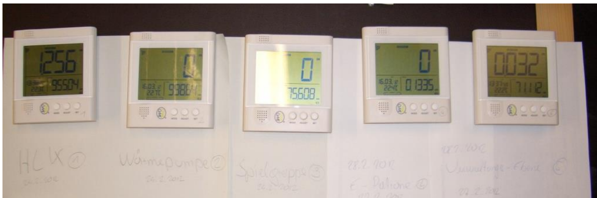
Abbildung 4: Empfangseinheiten der zeitlich hochaufgelösten dreiphasigen Stromzähler
